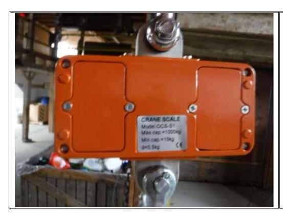
**Description:**Back of crane scale; Model #OCS-S1
